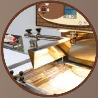
• System für die Positionierung der Luftströmung, das notwendig für den Überzug der Trüffel ist
